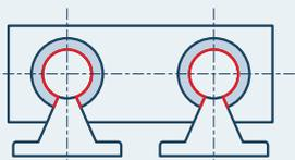
Con rodamiento lineal Super **A**, abierto, con compensación de errores de alineación
