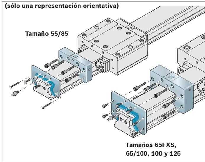
**Set para patines de rodillos anchos y patines de rodillos para cargas pesadas**
