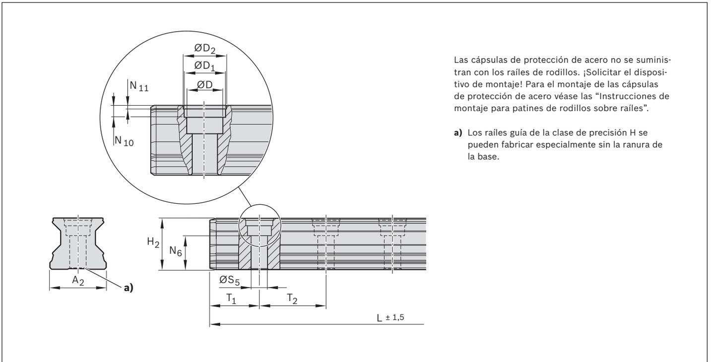
Las cápsulas de protección de acero no se suministran con los raíles de rodillos. ¡Solicitar el dispositivo de montaje! Para el montaje de las cápsulas de protección de acero véase las "Instrucciones de montaje para patines de rodillos sobre raíles".
