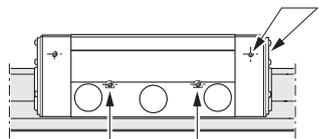
**y** en el cuerpo del patín de rodillos por todas las cuatro conexiones de lubricación laterales: por cada una  $7,5 \text{ cm}^3$  (x3)
