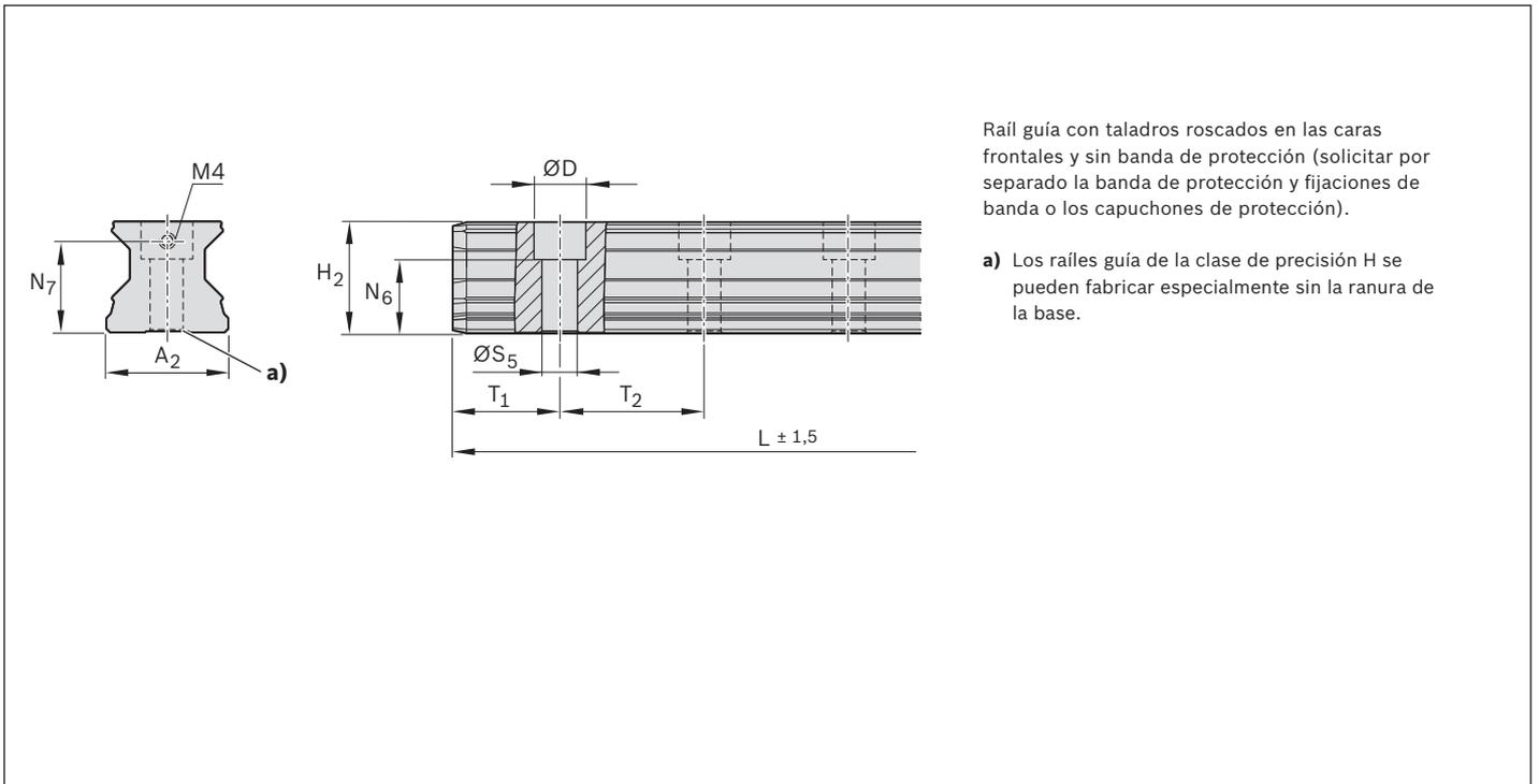
Raíl guía con taladros roscados en las caras frontales y sin banda de protección (solicitar por separado la banda de protección y fijaciones de banda o los capuchones de protección).
