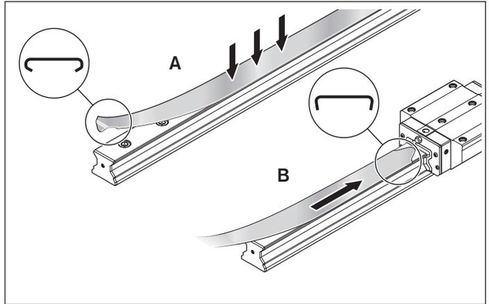
Con un mandril de expansión para las bandas de protección es posible también realizar posteriormente un area deslizante para poder retirar las bandas de protección. Sobre todo la longitud de desplazamiento  $L_s$  se adapta de forma óptima para cada tipo de aplicación. ¡Observar las instrucciones de montaje detalladas!
