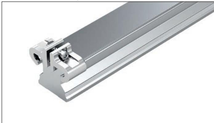
**Fijación por arriba, con banda de protección de acero inoxidable elástico según DIN EN 10088 y fijaciones de banda de aluminio (sin taladros roscados en las caras frontales)**
