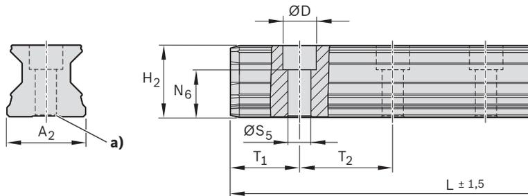
Las cápsulas de protección de plástico se suministran con los raíles de rodillos, y también pueden solicitarse como accesorio. Para el montaje de las cápsulas de protección de plástico véase las "Instrucciones de montaje para patines de rodillos sobre raíles".
