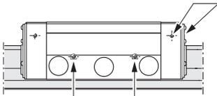
y en el cuerpo del patín de rodillos por todas las cuatro conexiones de lubricación laterales: por cada una 7,5 cm<sup>3</sup> (3x)
