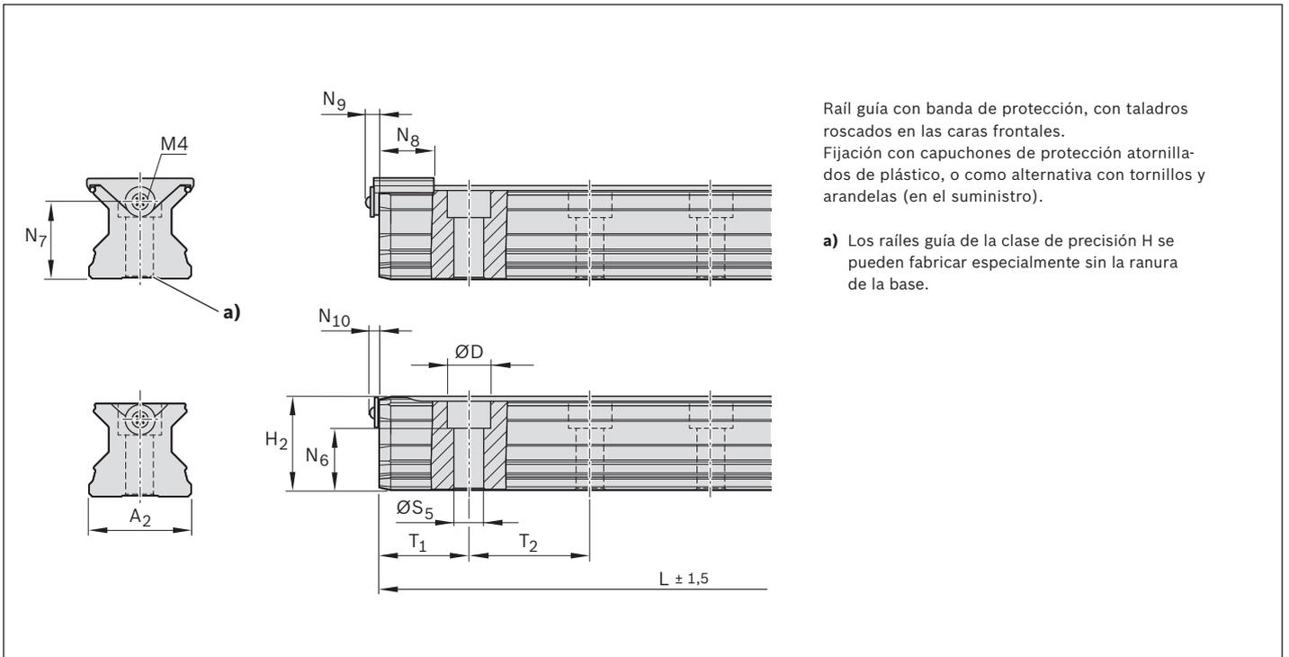
Rail guía con banda de protección, con taladros roscados en las caras frontales. Fijación con capuchones de protección atornillados de plástico, o como alternativa con tornillos y arandelas (en el suministro).
