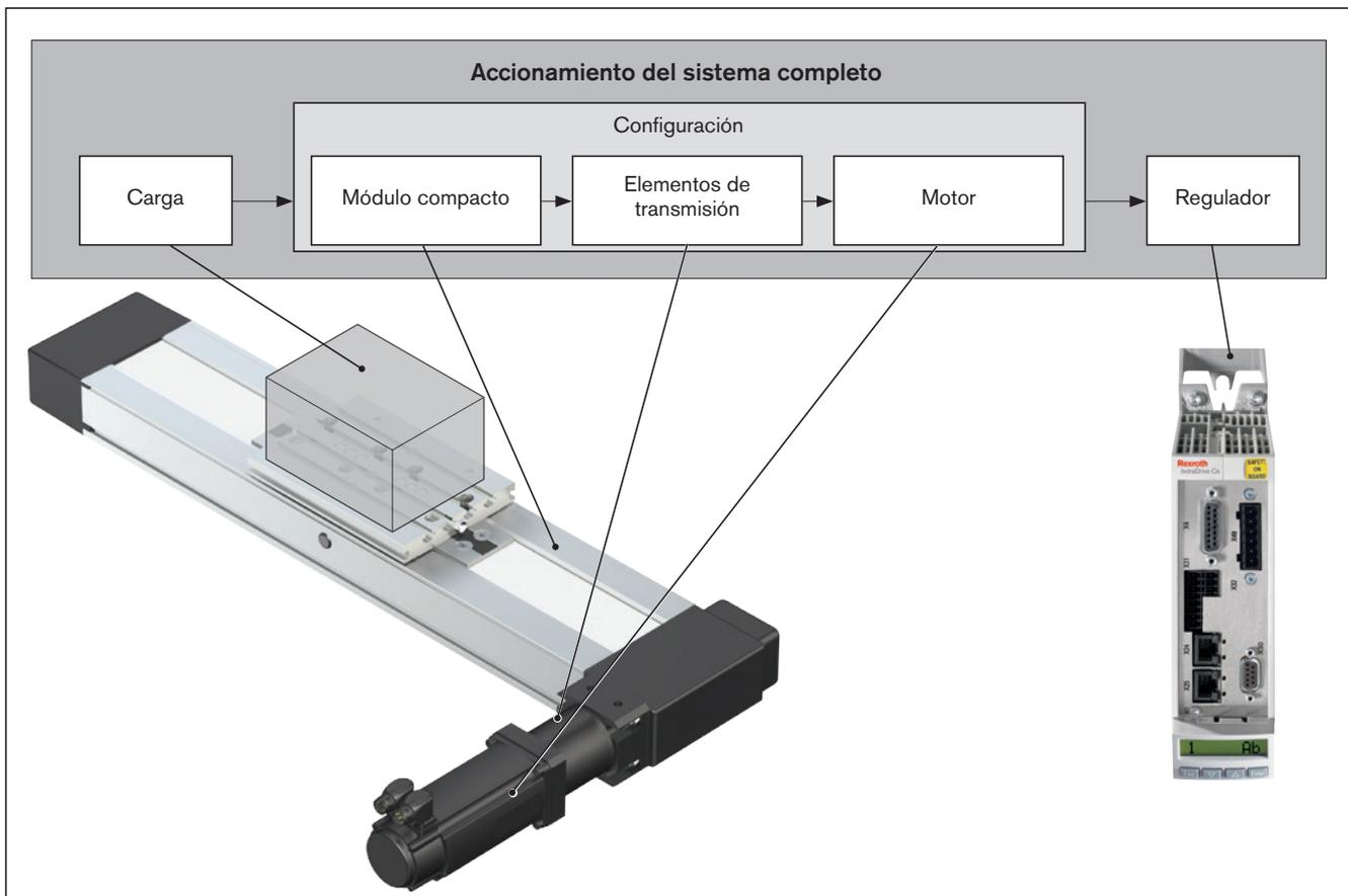
Para la evaluación y el dimensionado correcto de una aplicación se requiere un examen estructurado del sistema completo. La base para el sistema completo forma la configuración. Esta constelación entre el sistema lineal, el elemento de transmisión (reductor o directamente sin elemento de transmisión) y el motor puede solicitarse según el catálogo.
