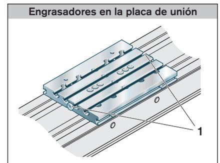
Cada placa de unión alberga en los frentes 2 engrasadores tipo embudo (1). Véase el capítulo "Placas de unión". Es suficiente si se lubrica por uno de los 2 engrasadores.
