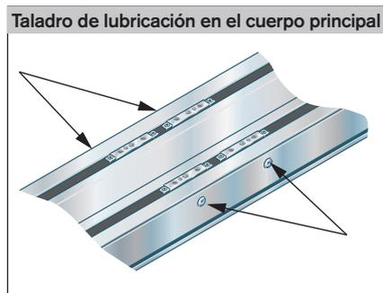
A ambos lados del cuerpo principal de los módulos compactos se encuentran los taladros por donde se puede llegar a los engrasadores de la mesa. Es suficiente si se lubrica de un solo lado.
