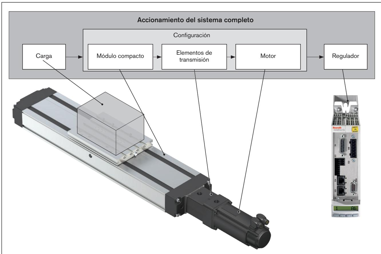
Para la evaluación y el dimensionado correcto de una aplicación se requiere un examen estructurado del sistema completo. La base para el sistema completo forma la configuración. Esta constelación entre el sistema lineal, el elemento de transmisión (acoplamiento o transmisión por correa dentada) y el motor puede solicitarse según el catálogo.
