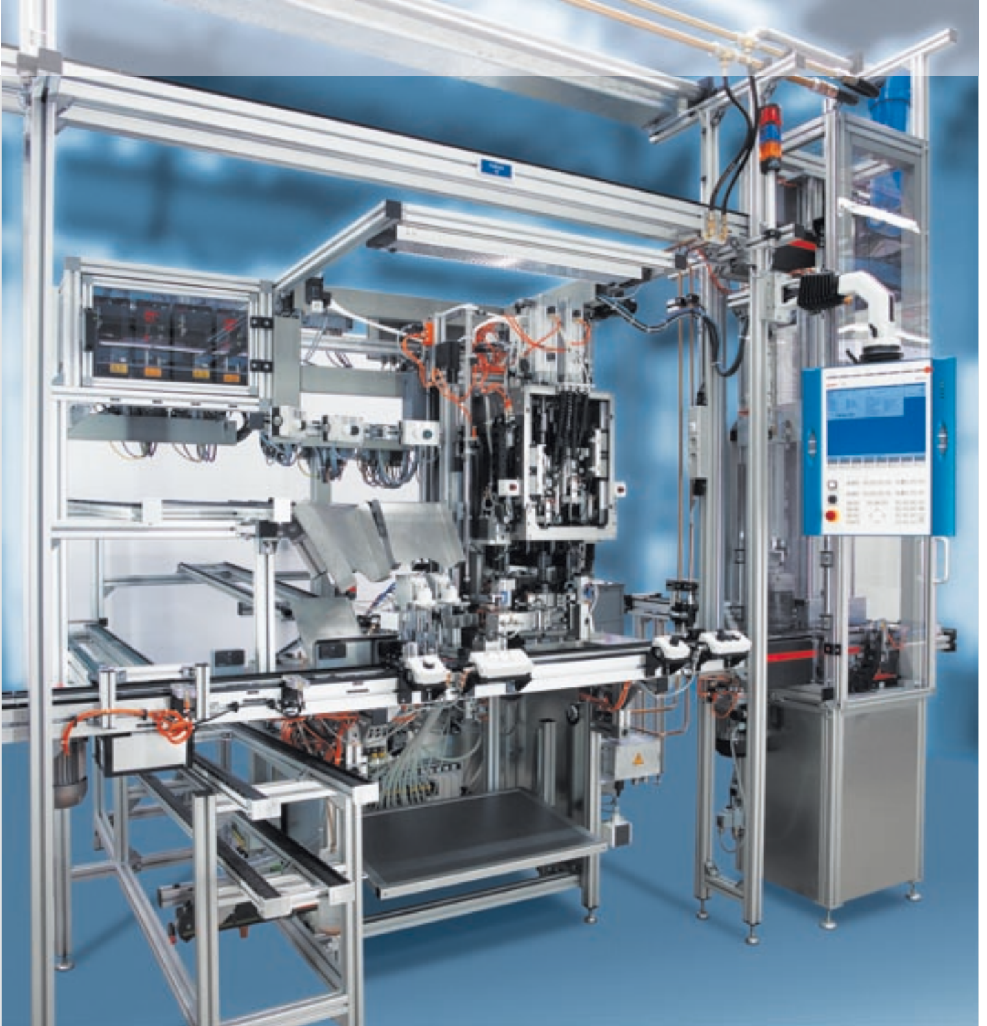
Linea flessibile con sistema di trasferimento e rifornimento manuale Línea flexible con sistemas transfer y alimentación manual Linha flexível com sistema transfer e alimentação manual Robert Bosch GmbH, Stuttgart, D
