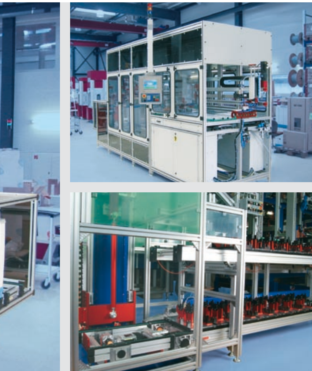
Cabina di montaggio flessibile con ascensore Célula de montaje flexible con ascensor Célula de montagem flexível com elevador LCA Automation AG, Affoltern, CH
