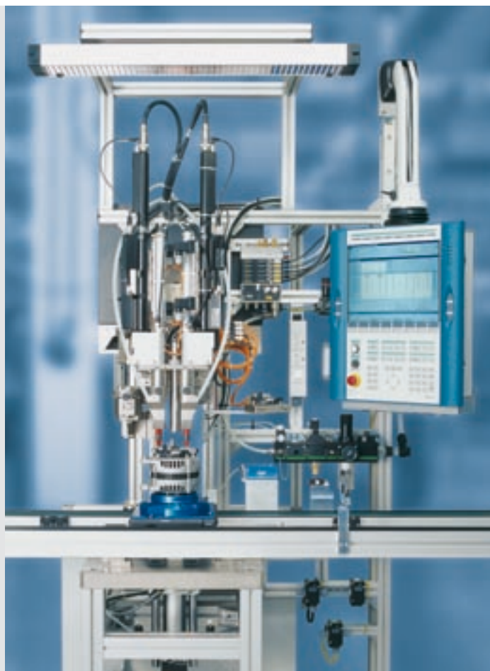
Stazione di avvitamento per la produzione di generatori Estación de atornillado para la producción de generadores Estação de parafusamento para a produção de geradores Robert Bosch GmbH, Stuttgart, D
