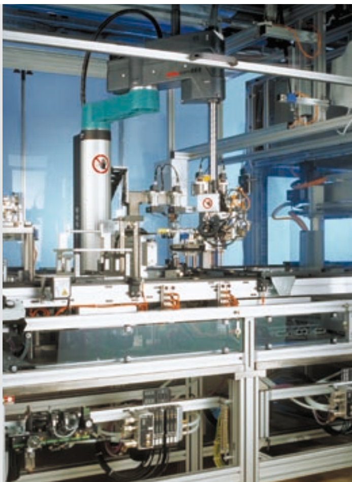
Cabina di lavoro del robot flessibile con sistema di trasferimento Célula de robot flexible con sistema transfer Célula de robô flexível para sistema transfer Robert Bosch GmbH, Stuttgart, D
