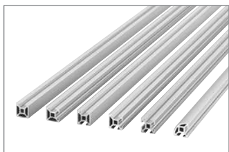
Perfiles de soporte con ranura de 6 mm, distancia entre ranuras de 20 mm (pág. 2-10)
